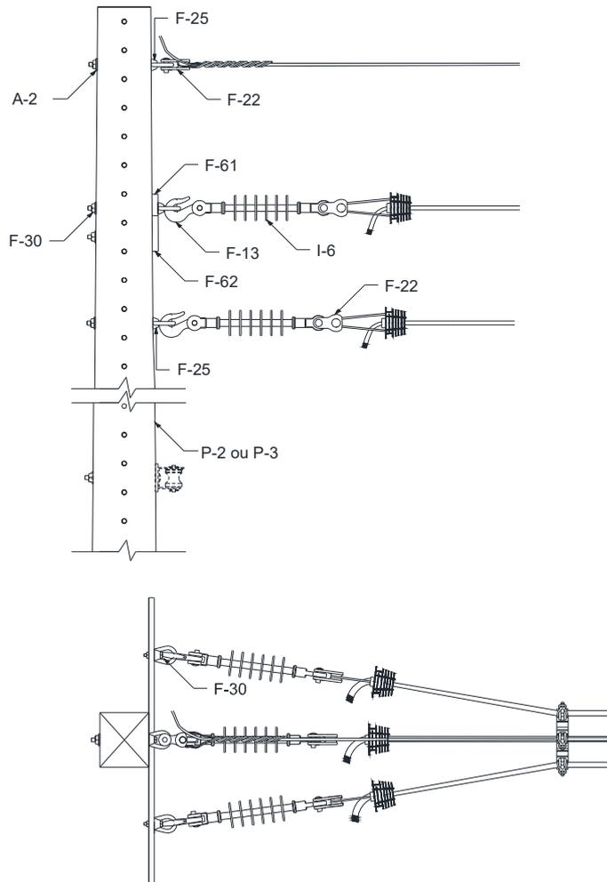
Figura 38 – Estrutura C3A – Poste de seção DT ou de madeira
