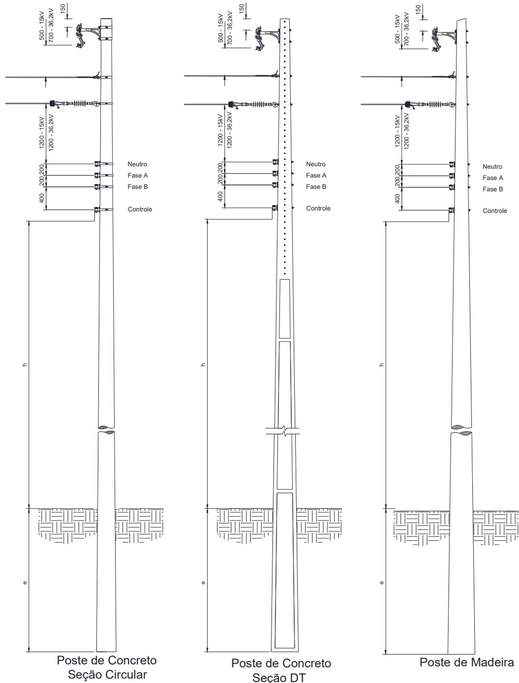
Figura 6 – Afastamentos mínimos – Estrutura monofásica tangente com derivação
