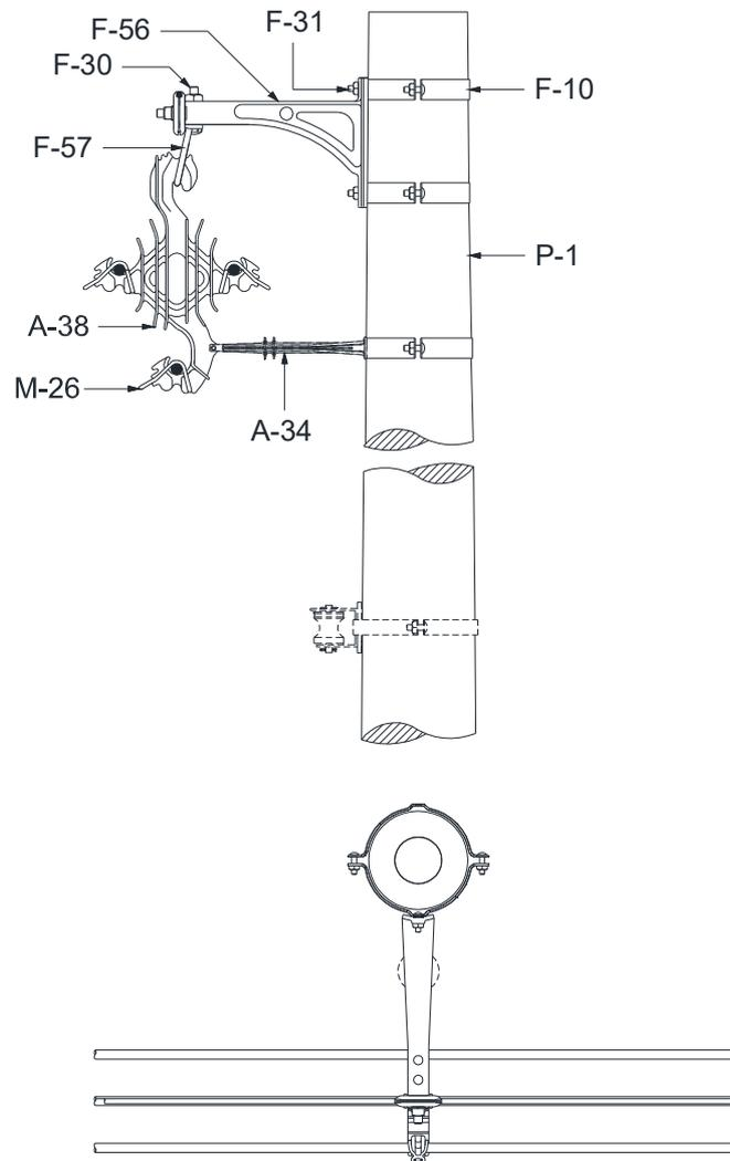
Figura 29 – Estrutura CA1 – Poste de seção circular
