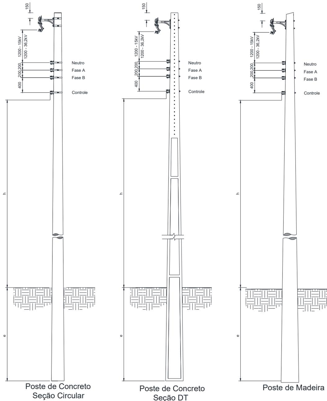
Figura 5 – Afastamentos mínimos – Estrutura monofásica tangente
