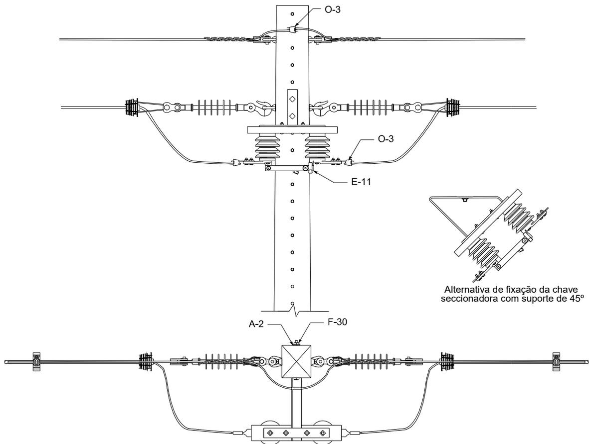
Figura 60 – Instalação de equipamento – Chave seccionadora – Estrutura monofásica
