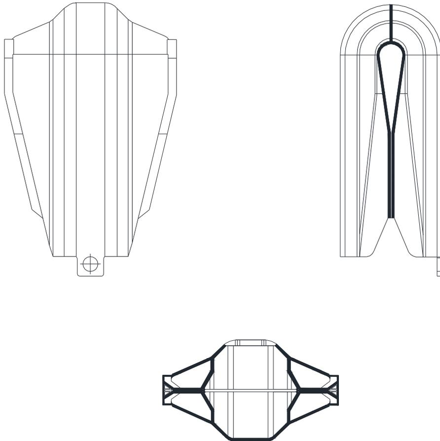
Figura 108 – Conexões e emendas – Capa protetora
