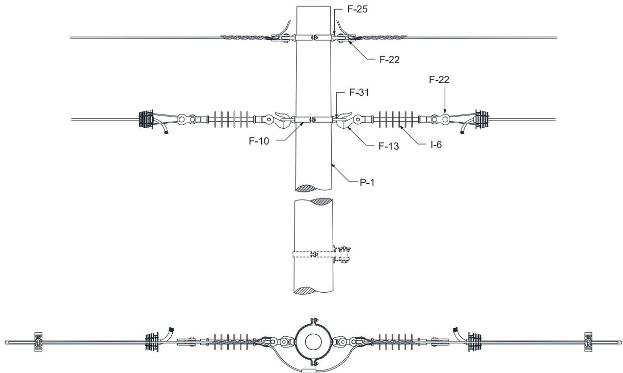
Figura 25 – Estrutura CU4 – Poste de seção circular
