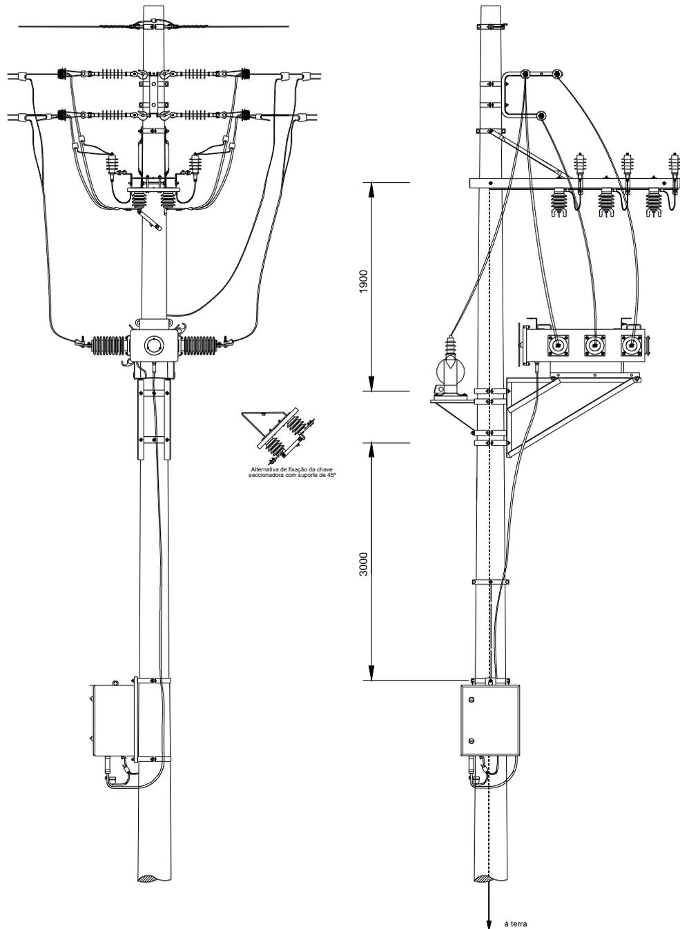
Figura 62 – Instalação de equipamento – Chave seccionadora tripolar
