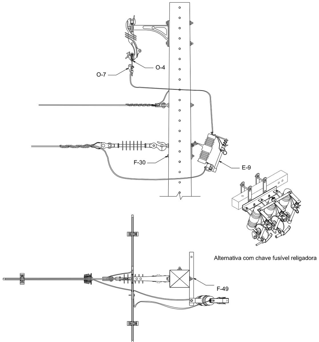
Figura 49 – Instalação de equipamento – Chave fusível em derivação monofásica – Estrutura monofásica – Alternativa
