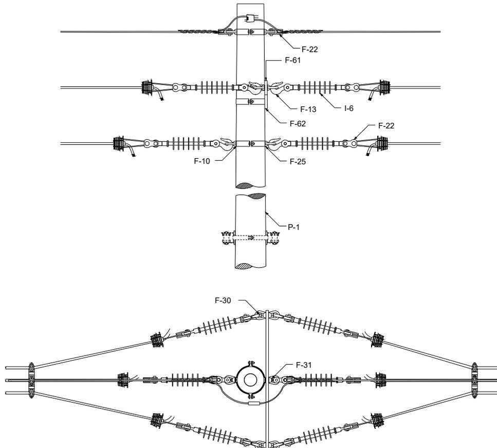
Figura 41 – Estrutura C4A – Poste de seção circular
