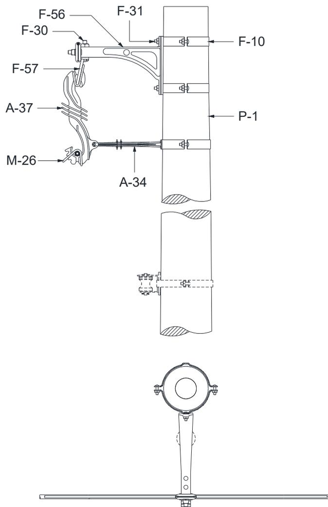
Figura 19 – Estrutura CU1A – Poste de seção circular
