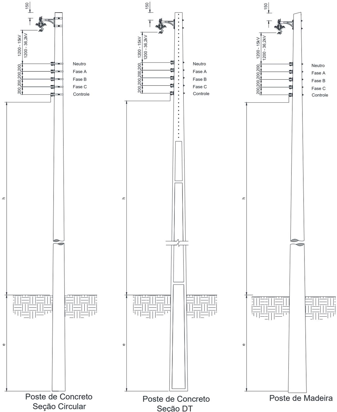
Figura 7 – Afastamentos mínimos – Estruturas trifásicas tangentes
