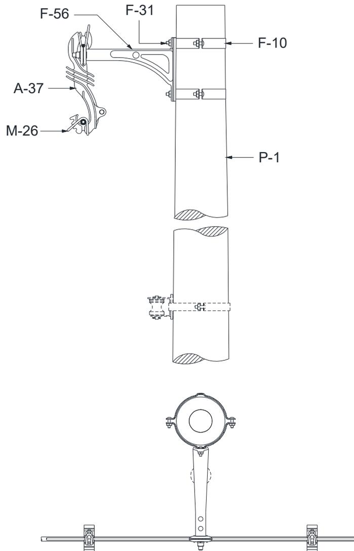
Figura 17 – Estrutura CU1 – Poste de seção circular
