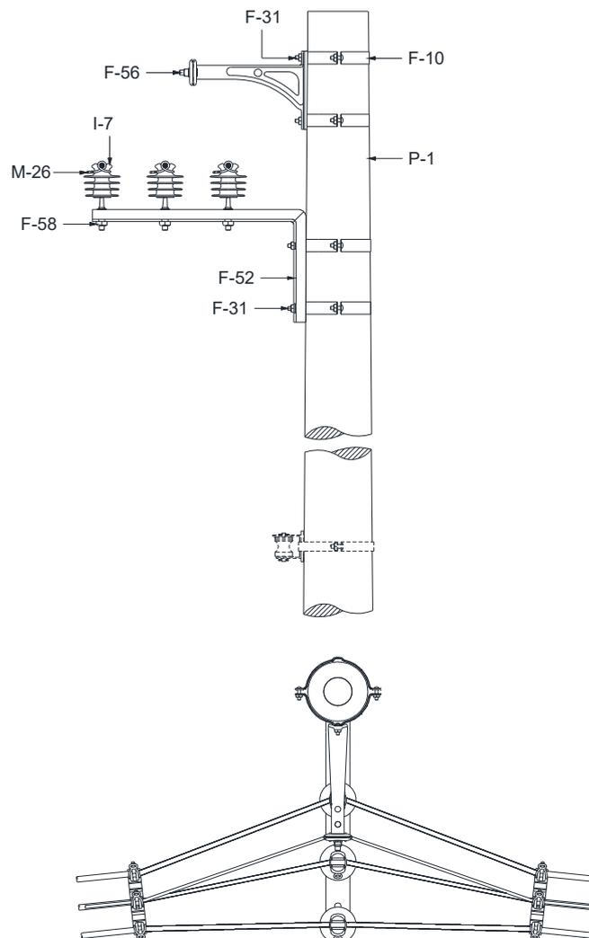
Figura 31 – Estrutura C1H – Poste de seção circular
