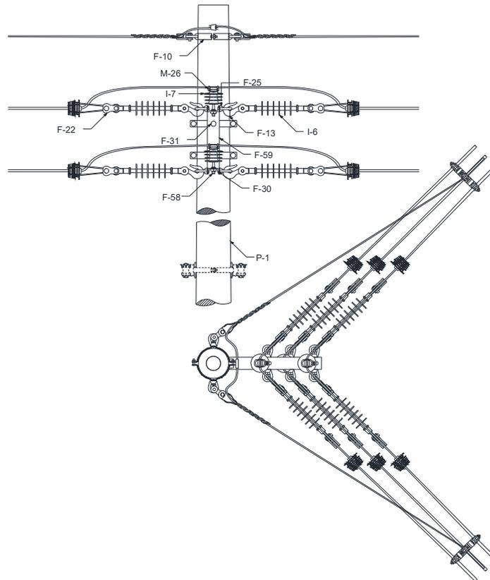
Figura 39 – Estrutura C4 – Poste de seção circular
