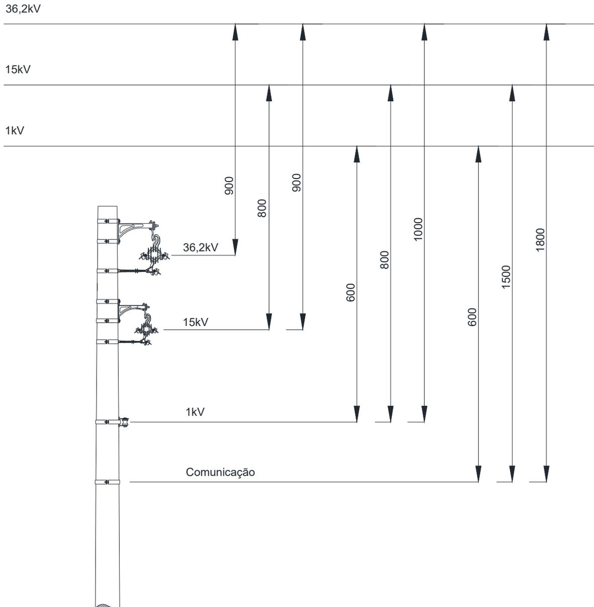
Figura 3 – Afastamentos mínimos – Circuitos diferentes
