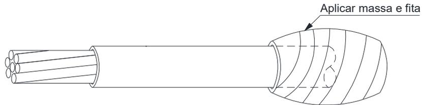
Figura 106 – Conexões e emendas – Rabicho
