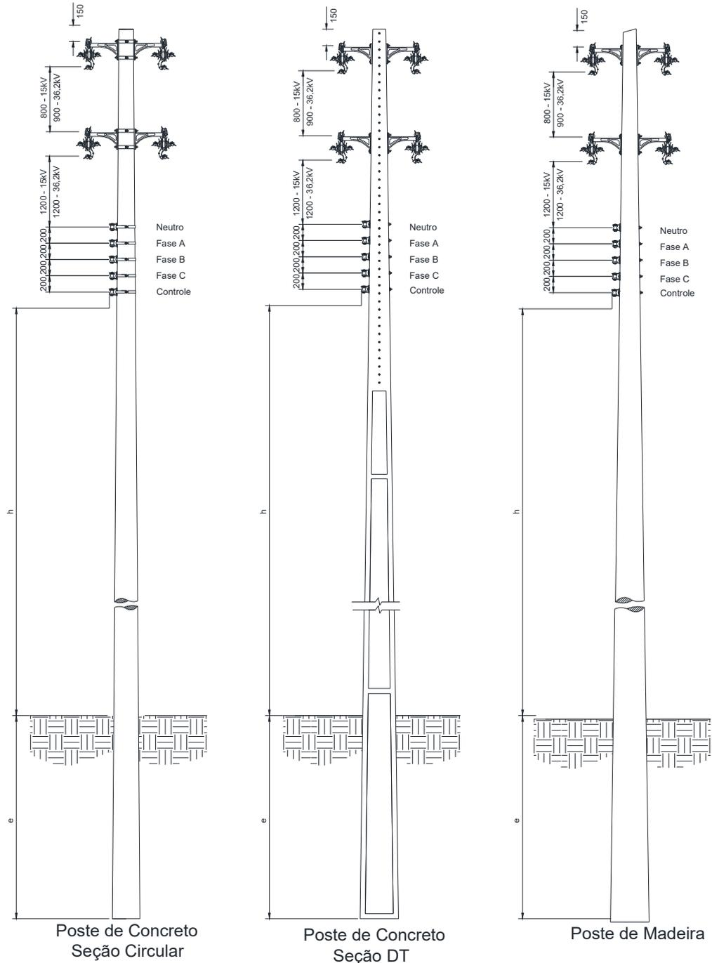
Figura 9 – Afastamentos mínimos – Estruturas trifásicas tangentes
