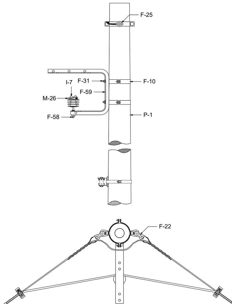
Figura 21 – Estrutura CU2 – Poste de seção circular
