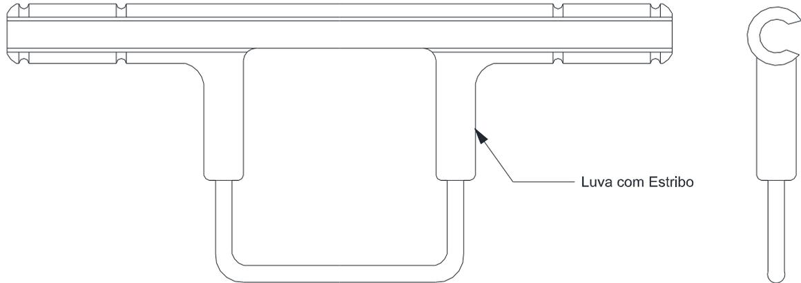
Figura 102 – Conexões e emendas – Conector luva estribo
