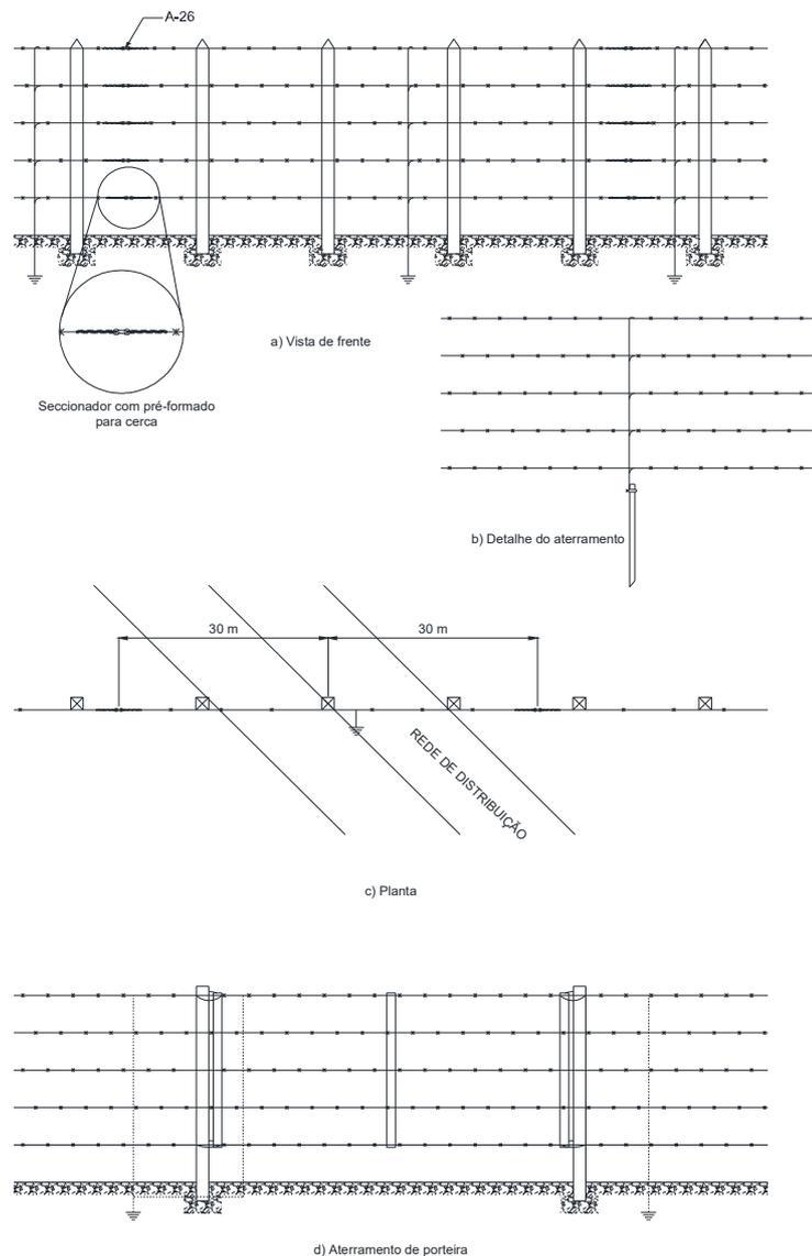
Figura 110 – Seccionamento de cerca – Cerca paralela
