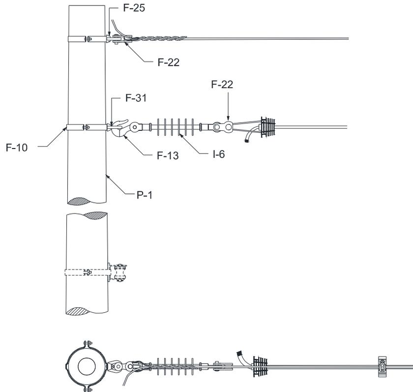
Figura 23 – Estrutura CU3 – Poste de seção circular
