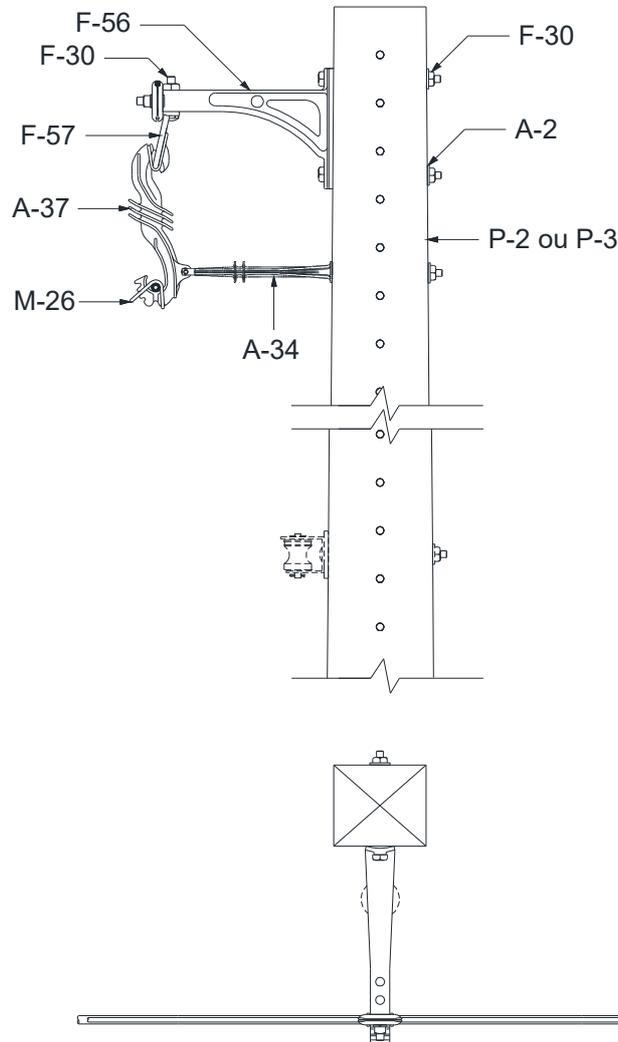
Figura 20 – Estrutura CU1A – Poste de seção DT ou de madeira
