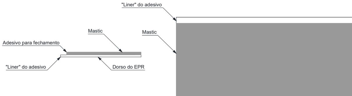
Figura 109 – Conexões e emendas – Manta de cobertura
