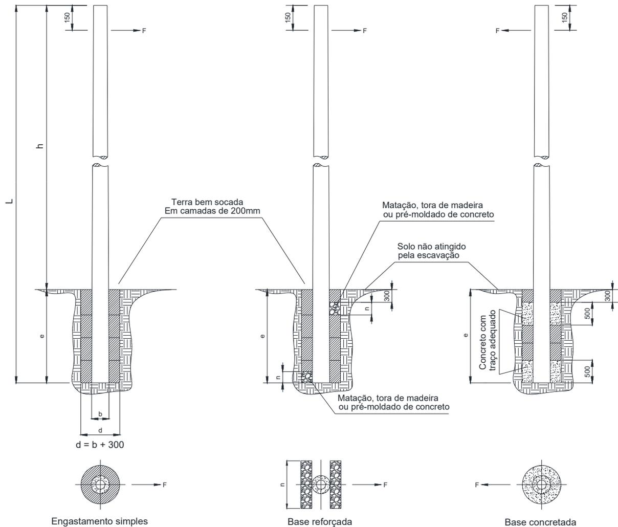
Figura 14 – Engastamento de poste – Detalhe da fundação
