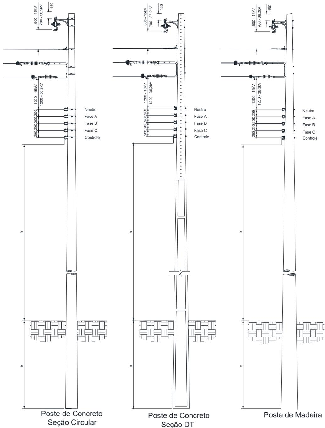
Figura 8 – Afastamentos mínimos – Estruturas trifásicas tangentes com derivações
