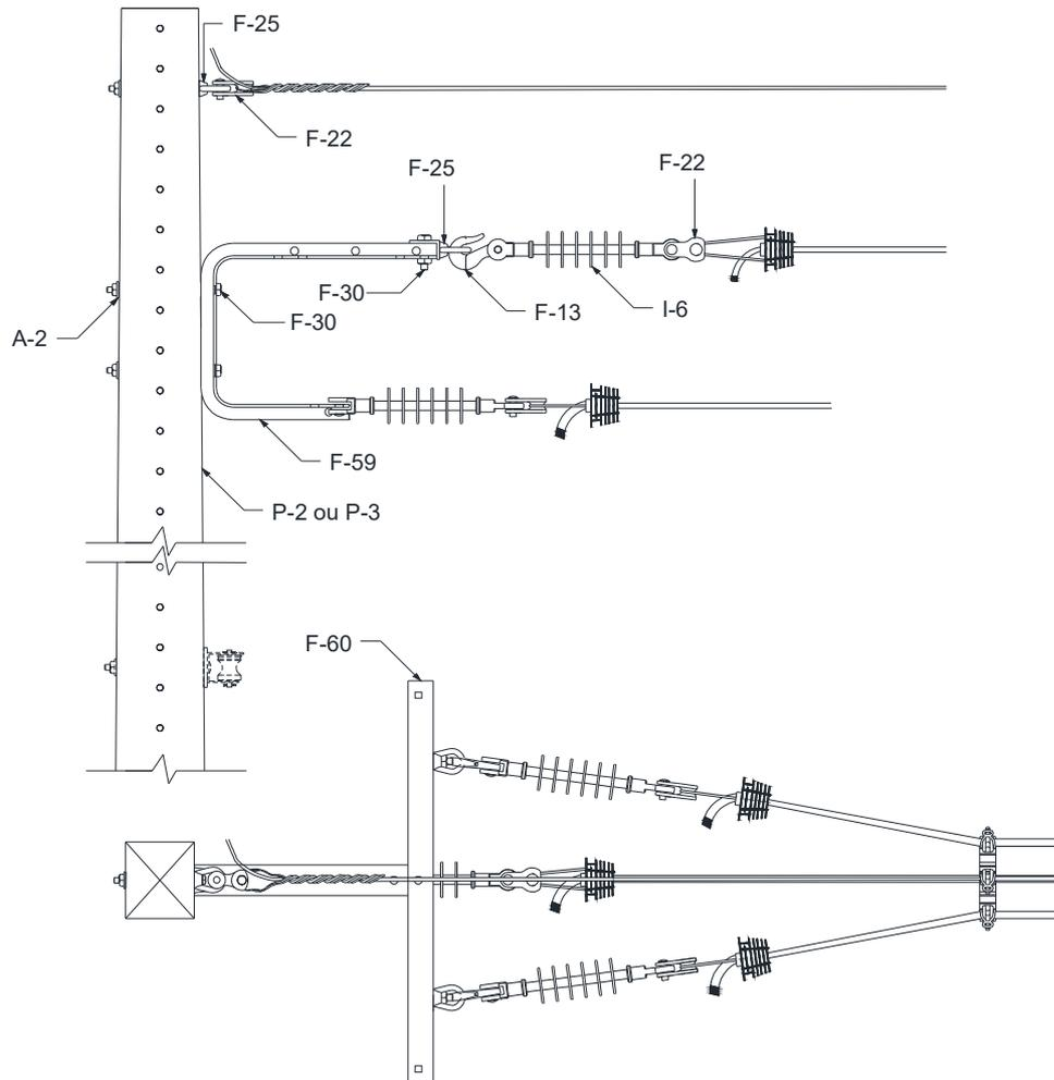
Figura 36 – Estrutura C3 – Poste de seção DT ou de madeira
