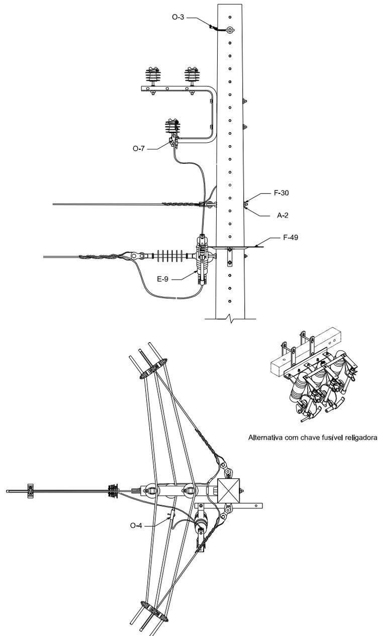
Figura 52 – Instalação de equipamento – Chave fusível em derivação monofásica – Estrutura trifásica
