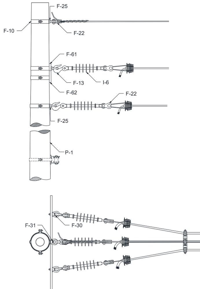
Figura 37 – Estrutura C3A – Poste de seção circular
