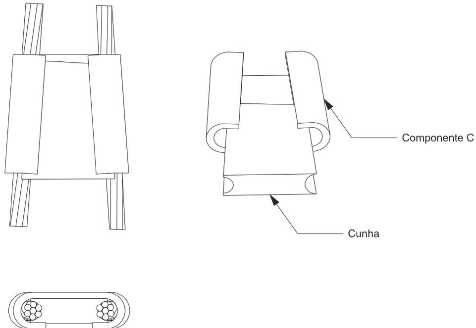
Figura 97 – Conexões e emendas – Conector cunha com estribo
