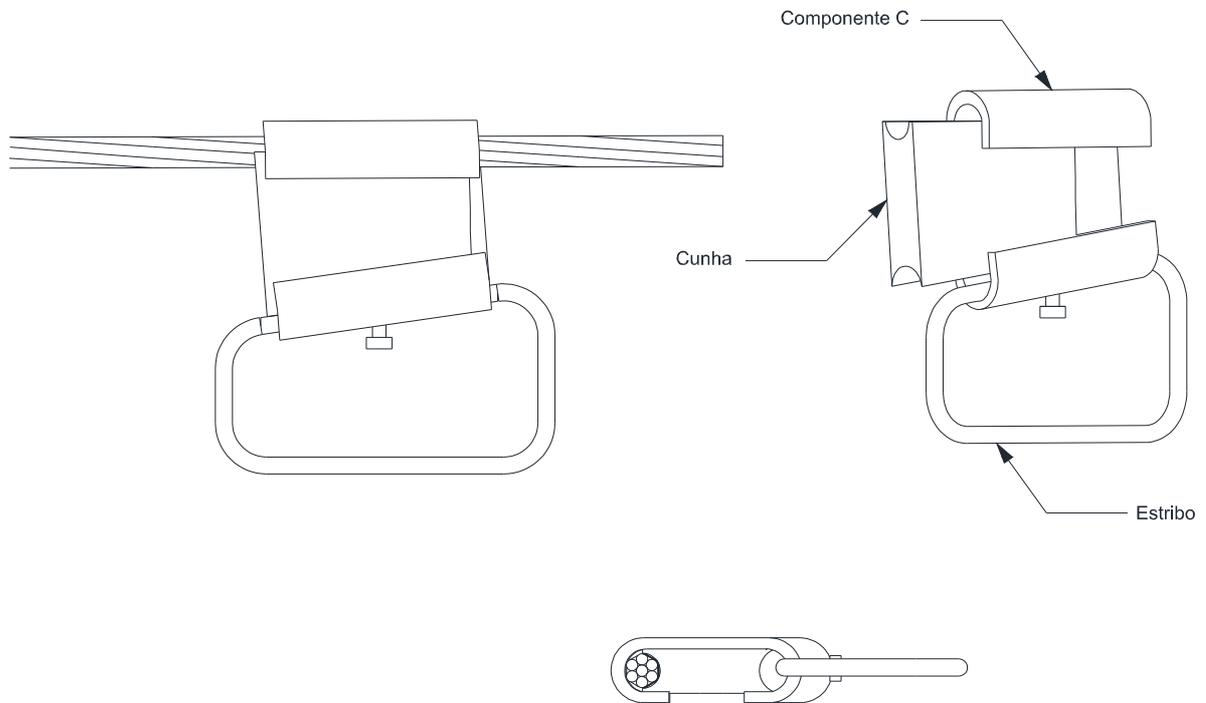
Figura 98 – Conexões e emendas – Conector cunha com estribo
