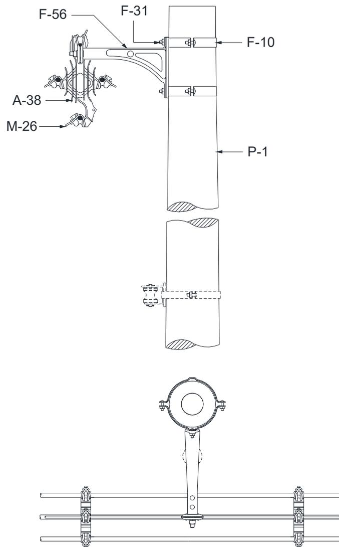
Figura 27 – Estrutura C1 – Poste de seção circular
