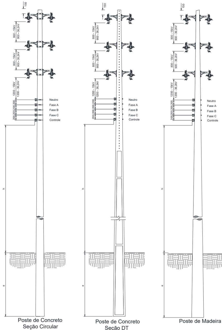
Figura 12 – Afastamentos mínimos – Estruturas trifásicas tangentes
