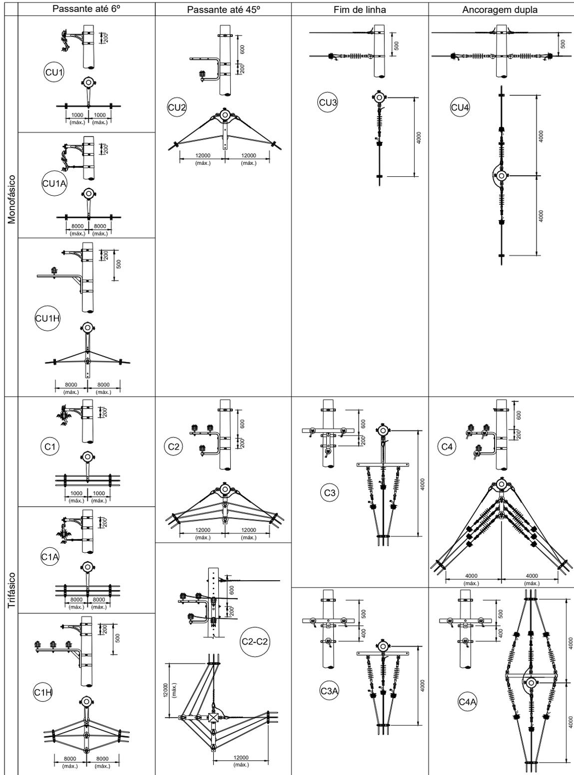
Figura 16 – Afastamentos mínimos de condutores nas estruturas
